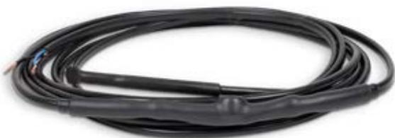
ETHERMA ICESTOP LIGHT ist die Variante mit nur 24 V und schützt Rohre vor Eis und in weiterer Folge vor Schäden. ICESTOP LIGHT ist ein anschlussfertiges Heizkabel mit Thermostat und einer konstanten Leistung von ca. 17 W/m. Das Thermostat ist zu 100 % feuchtigkeitsgeschützt und schaltet den Frostschutz bei Temperaturen unter + 3 °C ein und ab + 9 °C wieder aus. **NUR FÜR METALLROHRE GEEIGNET.**
