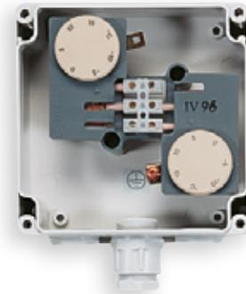
Bimetall-Doppelthermostat zur einfachen Regelung von Dachrinnenbeheizungen in Abhängigkeit der Temperatur, 2 Temperaturpunkte einstellbar. Nur für kleine Anlagen, bei größeren Anlagen empfehlen wir eine feuchte- und temperaturabhängige Steuerung.
