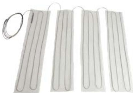
Die Treppenheizung NSP-TS ist ideal für die nachträgliche Verlegung auf bestehenden Treppen. Sie kann unter Fliesen im Kleberbett, unter Platten oder einem 2 cm starken, besonders rutschfesten und trittsicheren Polyurethanbelag verlegt werden. Vorteilhaft bei freitragenden Treppen. Werkseitig nach Planangabe konfektionierte, zusammenhängende Stufeneinzelmatte und gegebenenfalls Podeste, bestehend aus Glasseidennetz und robuster Spezialheizleitung mit dauerwasserfest angemuffter Anschlussleitung.
