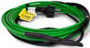
ETHERMA ICESTOP schützt Rohre vor Eis und in weiterer Folge vor Schäden. ICESTOP ist ein steckerfertiges Heizkabel mit einer konstanten Leistung von ca. 10 W/m. Das Thermostat ist zu 100 % feuchtigkeitsgeschützt und schaltet den Frostschutz bei Temperaturen unter + 3 °C ein und ab + 9 °C wieder aus.
