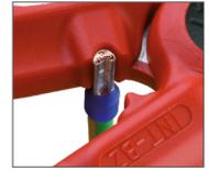
Spezialkerbe zum Crimpen (0,5 - 4 mm<sup>2</sup>)
