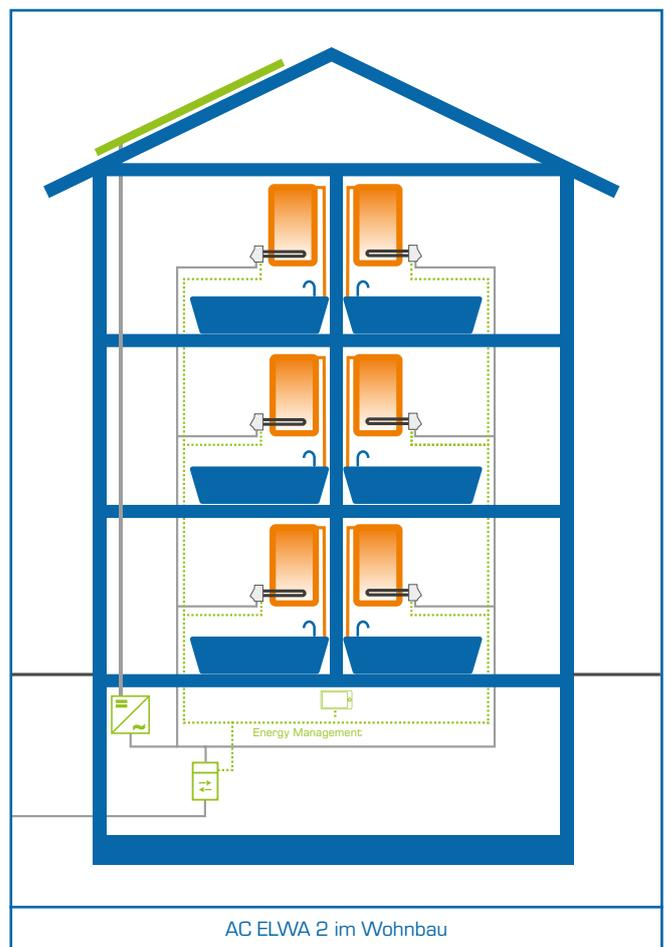
Durch dezentrale Speicherung und Warmwasserbereitung werden die üblichen Verteilverluste vermieden, bei gleichzeitig hygienischer Warmwasserbereitung. Die dezentralen AC ELWA 2 erzielen einen hohen solaren Deckungsgrad.
